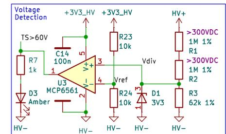
$$Vref\_max = 3.47V * 10.1k\Omega / (10.1k\Omega + 9.9k\Omega) = 1.76V$$
